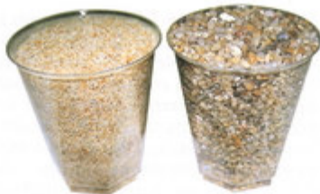
A gauche, silice filtrante dont la finesse (0,4 à 1,2 mm) assure la filtration. A droite, silice/support (2 à 5 mm) dont la présence en fond de cuve, autour des crépines, facilite la circulation de l'eau et sa répartition.
